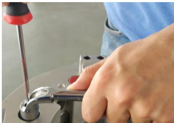
Рисунок 8. Поверните отверткой эксцентриковый вал по часовой стрелке до касания подшипника с ребордой, а затем затяните гайку эксцентрика.
