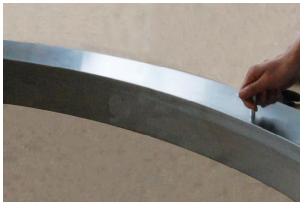
Рисунок 6 Вставьте позиционный штифт, чтобы предотвратить вращение планшайбы.
