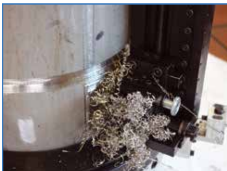
Продольное снятие сварного шва
