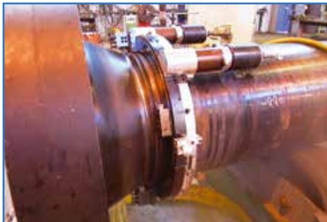
Сдвоенный мотор для предельны толщин
