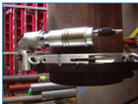
Угловой редуктор для операций с ограниченным доступом
