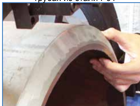
Резка и торцовка на большой толщине
