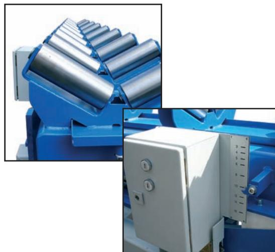
Все машины MFS оснащены дополнительной розеткой, к которой можно подключить рольганг. То есть для штекера RBT обязательно есть розетка.
